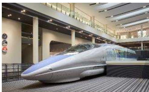
▲500 系新幹線電車 521 形 1 号車 世界で初めて営業運転で 300km/h を実現。先頭形状を長さ 15m にわたって鋭角に絞り込み、車体断面も航空機のように円形に近い形状となっているのが特徴。
