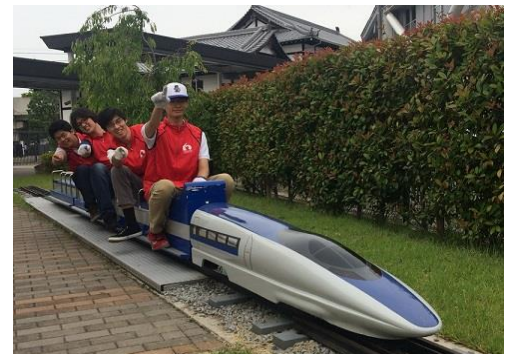
▲レール幅が5インチ(127mm)、実物のおよそ1/8サイズのミニ500系新幹線が走ります！
